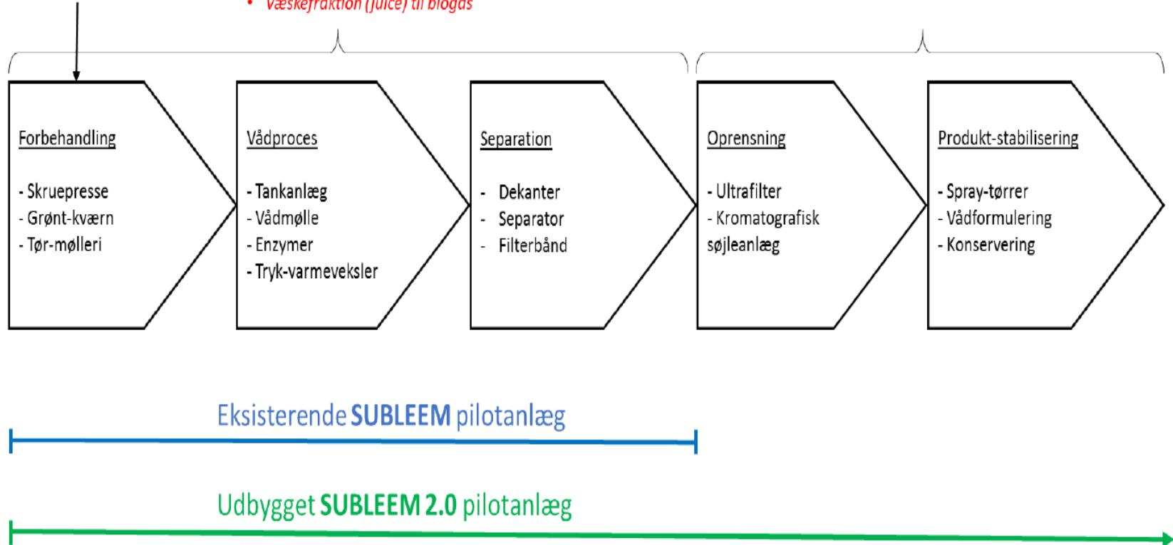
Figur 1. Overblik over processen for raffinering af grønne biomasser i det eksisterende SUBLEEM pilotanlæg og det udvidede SUBLEEM 2.0 pilotanlæg
