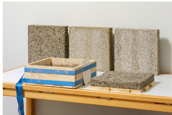
Test af materialepalette på vidensinstitution (u-værdi, akustik, fugt, skimmel)
